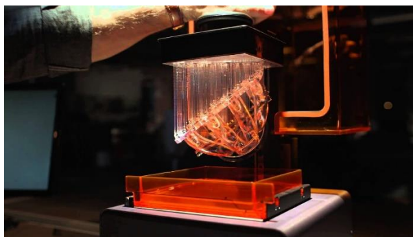
Сурет-1.1– SLA технологиясы көмегімен басып шығарылған Эйфел мұнарасының макеті
